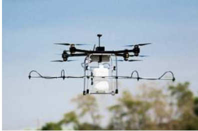
รูปที่ 4 รูปแบบของอากาศยานไร้คนขับแบบหลายใบพัด (Multi-rotor) กับการติดตั้งหัวฉีดสารละลาย
