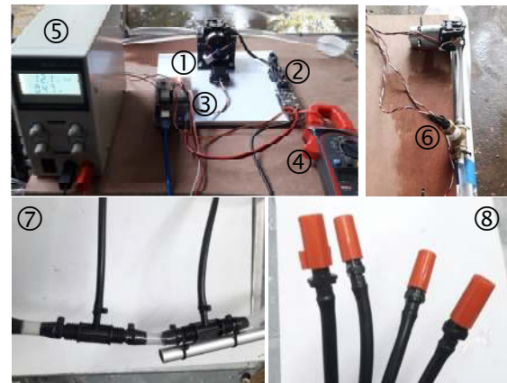
รูปที่ 3 อุปกรณ์ที่ใช้ในการทดลอง 1) ปั๊มและมอเตอร์ 2) ตัวขับเคลื่อนมอเตอร์ 3) Arduino สำหรับส่งสัญญาณ PWM และเชื่อมต่อกับคอมพิวเตอร์ 4) มิเตอร์วัดกระแสไฟ 5) ตัวจ่ายแรงดันไฟฟ้า 6) ตัววัดความดัน 7) ข้อต่อและท่อ และ 8) หัวฉีด
