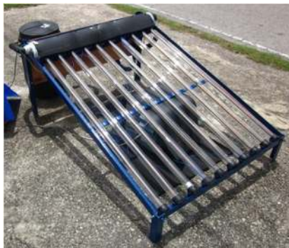
รูปที่ 2 แผนผังของเครื่องทำน้ำอุ่นพลังงานแสงอาทิตย์ จากท่อความร้อนที่ติดตั้งวัสดุพรุนภายใน
