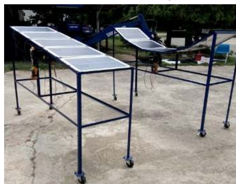
รูปที่ 1 แผงโซลาร์เซลล์ รุ่น 20 watts ต่ออนุกรมกัน ระบบละ 5 แผงเซลล์
