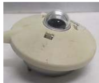
รูปที่ 2 ไพรานอมิเตอร์วัดความเข้มรังสีแสงอาทิตย์ เครื่องวัดค่าความเข้มแสงอาทิตย์ รุ่น CM11 มี
