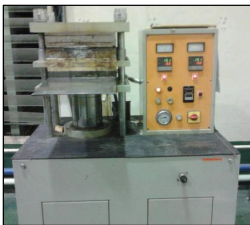
รูปที่ 2 กระบวนการอัดขึ้นรูปร้อนด้วยเครื่อง Compression molding machine
