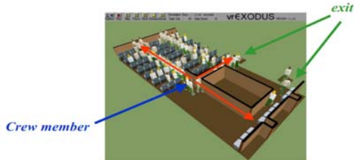
รูปที่ 1 การจำลองการอพยพผู้โดยสารภายในเครื่องบิน โดยใช้โปรแกรม Exodus [2]
