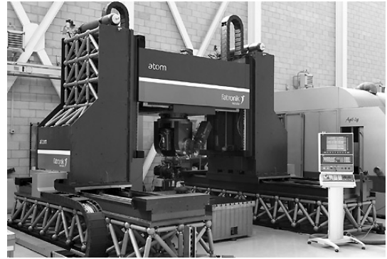
ภาพที่ 2 เครื่องจักรกลซีเอ็นซีต้นแบบที่ใช้โครงสร้างเครื่องจักรแบบโครงถัก [2]
