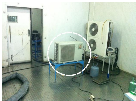
รูปที่ 3 ห้องทดสอบด้านคอนเดนซิ่งยูนิต
